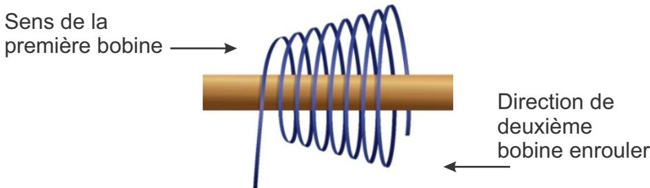
Quand on enveloppe sur tuyau de cuivre, il faut assurer que les bobines sont toujours enroulées autour du tuyau au niveau de la même direction.
