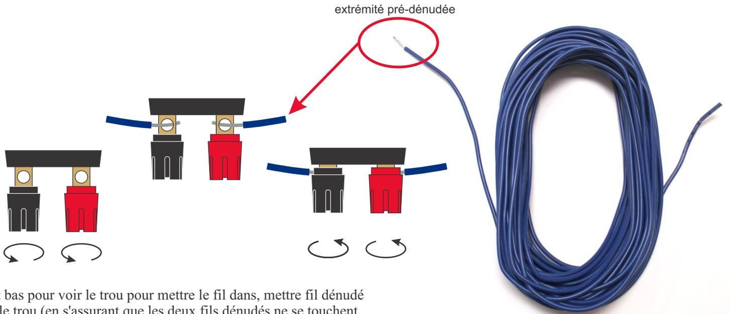
Twist bas pour voir le trou pour mettre le fil dans, mettre fil dénudé dans le trou (en s'assurant que les deux fils dénudés ne se touchent pas) puis tournez à serrer.
