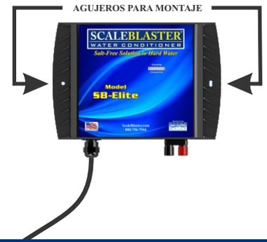
La imagen del extremo derecho muestra la ubicación de los orificios de montaje. El instalador deberá proporcionar los tornillos de montaje para el tipo de superficie se montará la unidad. Un tornillo número 8 funciona mejor.
